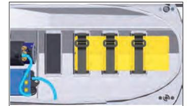
**Batteriepacks hinten:** Bei ruhigem Wasser und Windstille können Sie die Batteriepacks weiter hinten im Rumpf positionieren, damit der Bug weiter aus dem Wasser herauskommt, um so die Geschwindigkeit des Spartan SRs zu erhöhen. Wenn Sie die Batterien zu weit hinten platzieren, erhöht sich die Wahrscheinlichkeit, dass das Boot sich bei hoher Geschwindigkeit überschlägt oder instabil wird.
