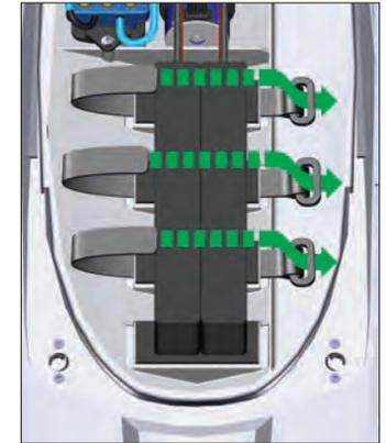
**Positionieren der Batteriepacks**
