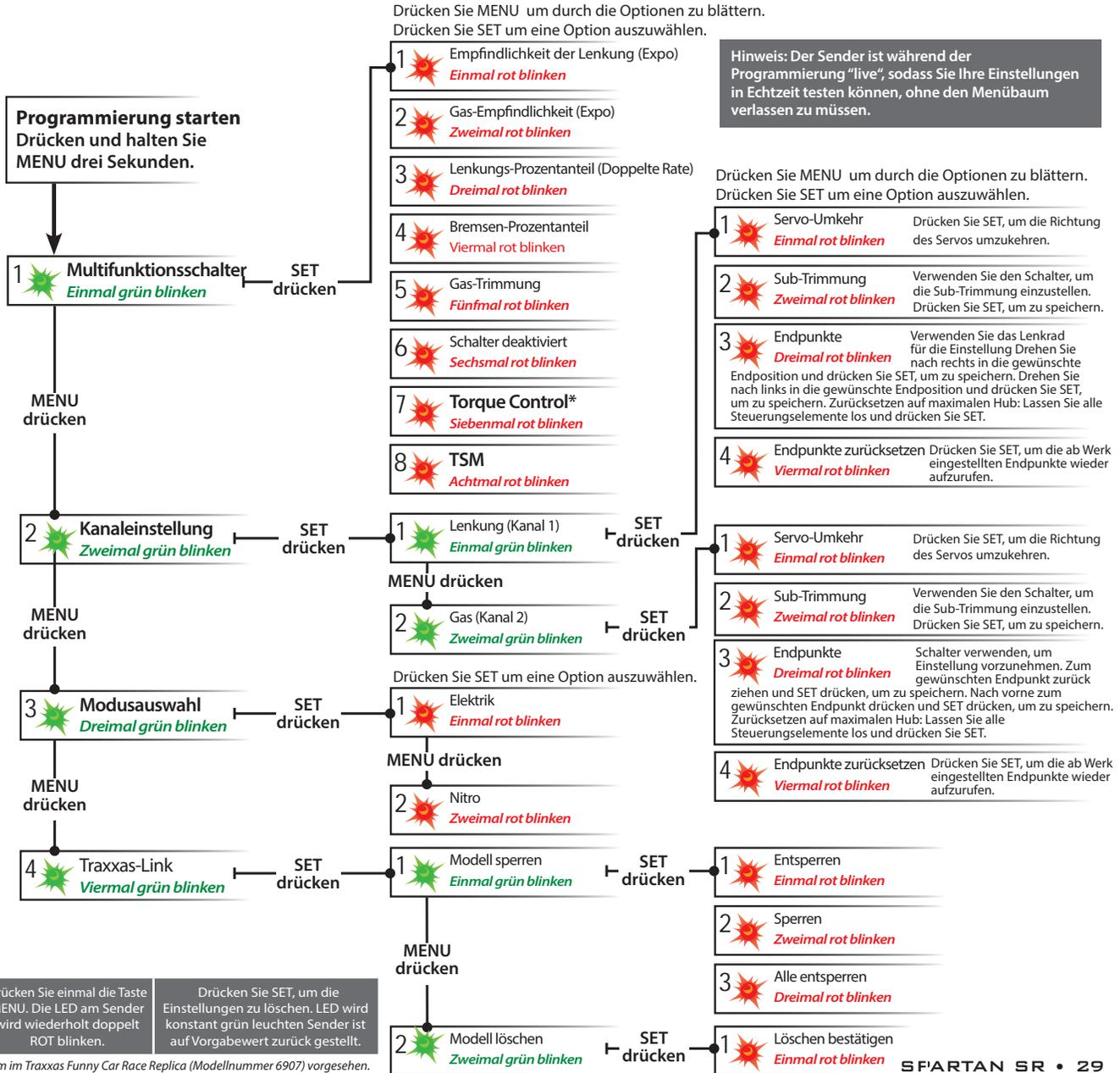
Die Funktion Torque Control ist speziell für die Verwendung mit dem Stromversorgungssystem im Traxxas Funny Car Race Replica (Modellnummer 6907) vorgesehen.
