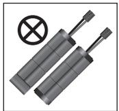
Benutzen Sie keine 6-Zellen 7,2 V Batterie in Verbindung mit einem 7-Zellen 8,4 V Batterie-Pack.
