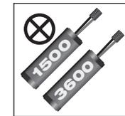
Vermischen Sie nicht Batterien mit unterschiedlicher Kapazität. Benutzen Sie zwei Batterien mit der gleichen Kapazität.
